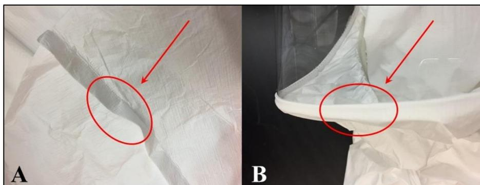
**Figure 45. A) Tyvek-Tyvek seam, B) Tyvek-visor seam.**
